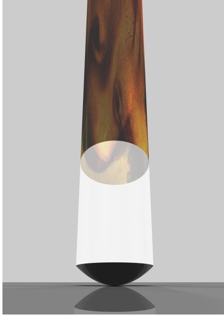
FIG. 2 – Une vue générale du dispositif en contre-plongée. La limite supérieure de la zone vierge sur le cylindre correspond à l’altitude minimale des rayons réfléchis, obtenus en traçant la droite partant du bord du miroir et passant par le point focal de la parabole (image de synthèse obtenue avec Povray).
